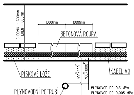
KŘÍŽENÍ KABELU VO A PLYNOVODU
